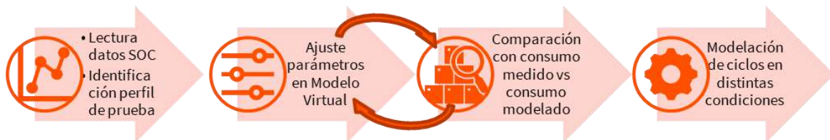
Figura 12. Metodología utilizada para el diseño de buses virtuales y modelación de perfiles. (Fuente: De autoría, Centro Mario Molina)
