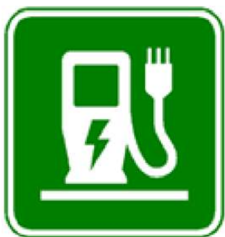
Figura 35. Señalética que debe contar el IRVE. La altura (h), corresponde a un valor en el rango 1.8 y 2.0 m. (Fuente: SEC)
